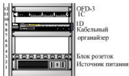
Рисунок 4 – Схема размещения оборудования в коммутационном шкафу
